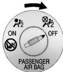
Si el tablero de instrumentos tiene el interruptor que aparece en la ilustración, el vehículo tiene un interruptor de encendido-apagado de bolsa de aire que puede usar para activar o desactivar en forma manual la bolsa de aire del pasajero externo.
