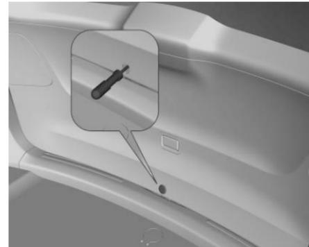
Para abrir la compuerta levadiza en el caso de interrupción de energía: retire la cubierta de la moldura interior del área del seguro central. Empuje una herramienta adecuada hacia adentro tanto como sea posible y gírela en sentido contrario al de las manecillas del reloj para abrir la puerta trasera.
