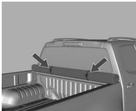
5. Sujete los lados flexibles de la cubierta Tonneau en el soporte del riel lateral.
