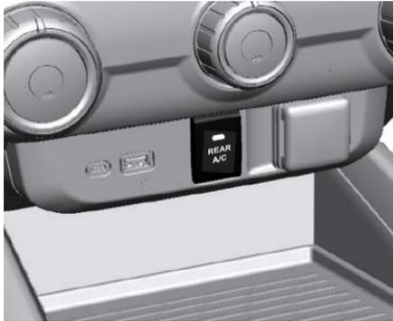
Si está equipado, el sistema de aire acondicionado trasero se opera con el botón **REAR A/C**.
