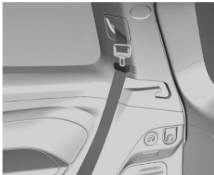
Guíe los cinturones de seguridad a través de los soportes del cinturón para asegurar que los asientos de tercera fila no se atoren durante el almacenamiento de los asientos.
