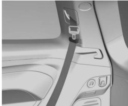
Guíe los cinturones de seguridad a través de los soportes del cinturón para asegurar que los asientos de tercera fila no se atoren mientras los asientos se levantan.
