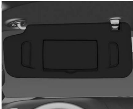
Las viseras pueden tener espejos de vanidad. Cuando las cubiertas del espejo de vanidad están abiertas, se enciende la luz de la visera. Las cubiertas del espejo se deben cerrar cuando conduzca.
