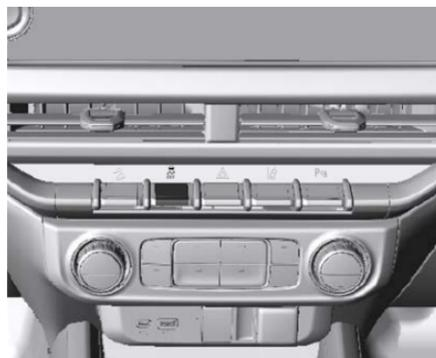
El Control de tracción se puede apagar cuando se requiere el deslizamiento de la rueda de tracción presionando el botón
