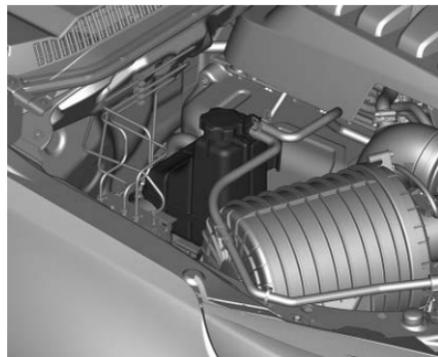
Si el sistema de enfriamiento está frío, el nivel del refrigerante debería estar 1 cm por encima de la marca de la línea de llenado. Rellene si el nivel está bajo.
