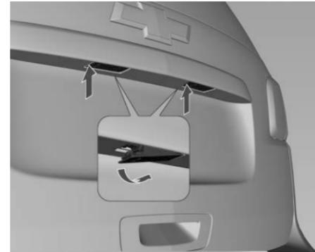
1. Inserte un destornillador en el lado izquierdo del alojamiento del foco, presione el costado y libere el resorte.
