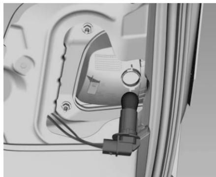
4. Retire el foco del soporte. Presione el foco dentro del receptáculo ligeramente para insertarlo.
