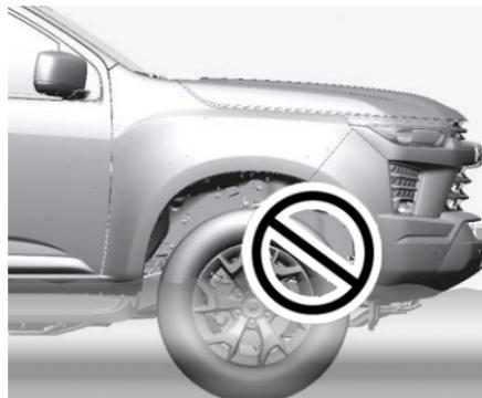
Conduzca a baja velocidad a través de cualquier área inundada y asegúrese de que el límite del agua no supere la altura del centro de la rueda. Evite conducir cerca de vehículos grandes. Se pueden crear olas que pueden causar daños.
