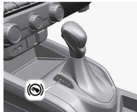
Si no se aplica el pedal de freno, el indicador de control (P/R) se ilumina.
