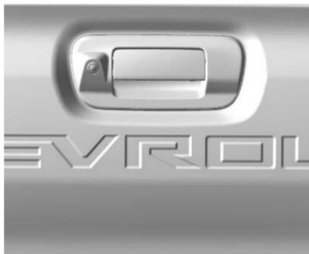
Para abrir la puerta trasera, el vehículo debe estar apagado o detenido, con la palanca de cambios en P (estacionamiento), si está equipado.
