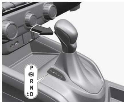
**P:** posición de estacionamiento, las ruedas están bloqueadas, enganche solamente cuando el vehículo esté estacionario y esté aplicado el freno de estacionamiento.
