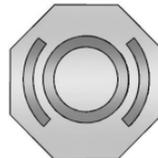
El tapón del depósito del líquido de frenos/embrague hidráulico tiene este símbolo. El depósito común del fluido de embrague/frenos se llena con líquido de frenos DOT 4LV, como se indica en el tapón del depósito. Vea en *Vista general del compartimiento del motor* ⇨ 219 la ubicación del depósito.
