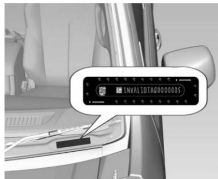
El Número de identificación del vehículo está grabado en el tablero de instrumentos y es visible a través del parabrisas.
