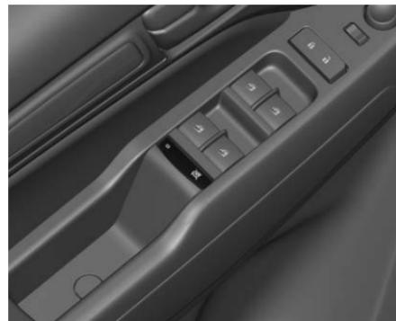
Oprima el interruptor
