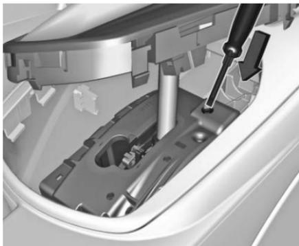
3. Inserte un destornillador en la abertura lo más que se pueda y saque la palanca selectora de la posición P. Si se vuelve a colocar P, la palanca selectora se bloqueará en la posición de nuevo. Conduzca a un Distribuidor Chevrolet o Taller de Reparación Autorizado tan pronto como sea posible para verificar y reparar.
