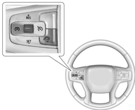
: Presione para activar o desactivar el Limitador de velocidad. Cuando está seleccionado el Limitador de velocidad, la luz indicadora de Limitador de velocidad se muestra en blanco en el cuadro de instrumentos.
