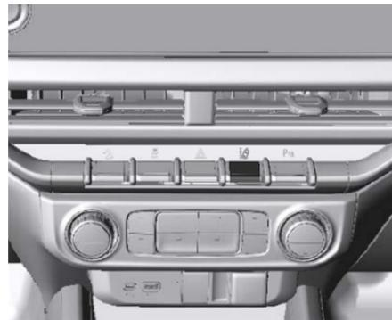
Si está equipado, LDW puede ayudar a evitar choques debido a alejamientos involuntarios del carril. Puede proveer una alerta si el vehículo está cruzando un carril sin usar una direccional en esa dirección. LDW utiliza una cámara para detectar las marcas de carril a velocidades de 56 km/h (35 mph) o mayores.
