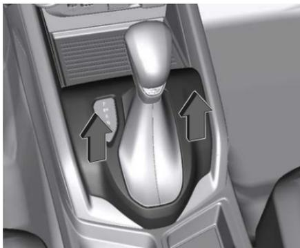
2. Presione la cubierta de la palanca selectora de la consola central en la parte trasera para liberar, doble hacia arriba y gírela a la izquierda.
