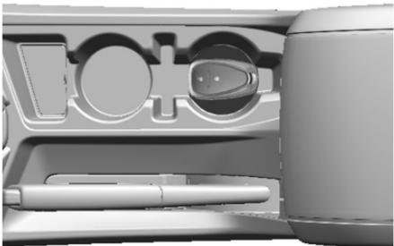
1. Coloque la llave no remota o el transmisor en la consola central o en el descansabrazos. Las posiciones correctas se muestran en las figuras.
